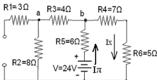
$$\begin{aligned} \text{Η ισοδύναμη αντίσταση που βλέπει η πηγή είναι :} \\ R_{eq} &= R_5 + [(R_3 + R_2) // (R_4 + R_6)] = \\ &= 6 + [(4 + 8) // (7 + 5)] = 6 + [12 // 12] = 6 + 6 \\ &\Rightarrow R_{eq} = 12\Omega \end{aligned}$$
