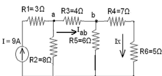
$$\begin{aligned} \text{Το ρεύμα των } 9A \text{ διακλαδίζεται στον κόμβο a} \\ \text{επάνω στην αντίσταση } R_2 = 8\Omega \text{ και στον κλάδο} \\ \text{με ισοδύναμη αντίσταση } R'_{eq} \text{ όπου} \\ R'_{eq} &= R_3 + [R_5 // (R_4 + R_6)] = 4 + [6 // (7 + 5)] = \\ &= 4 + [6 // 12] = 4 + (6 \times 12) / (6 + 12) = 4 + 4 \\ &\Rightarrow R'_{eq} = 8\Omega \end{aligned}$$
