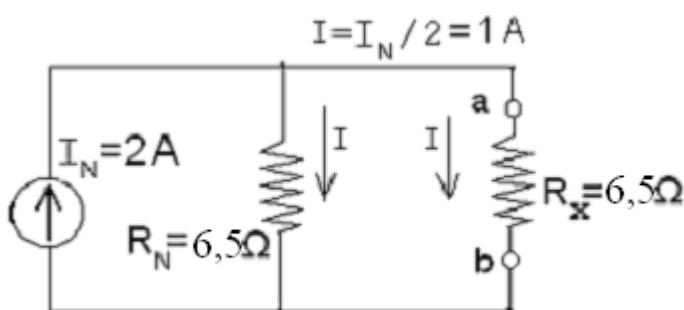
και έτσι προκύπτει  $I_N = V_{th} / R_{th} = 13 \text{ V} / 6,5 \Omega$
