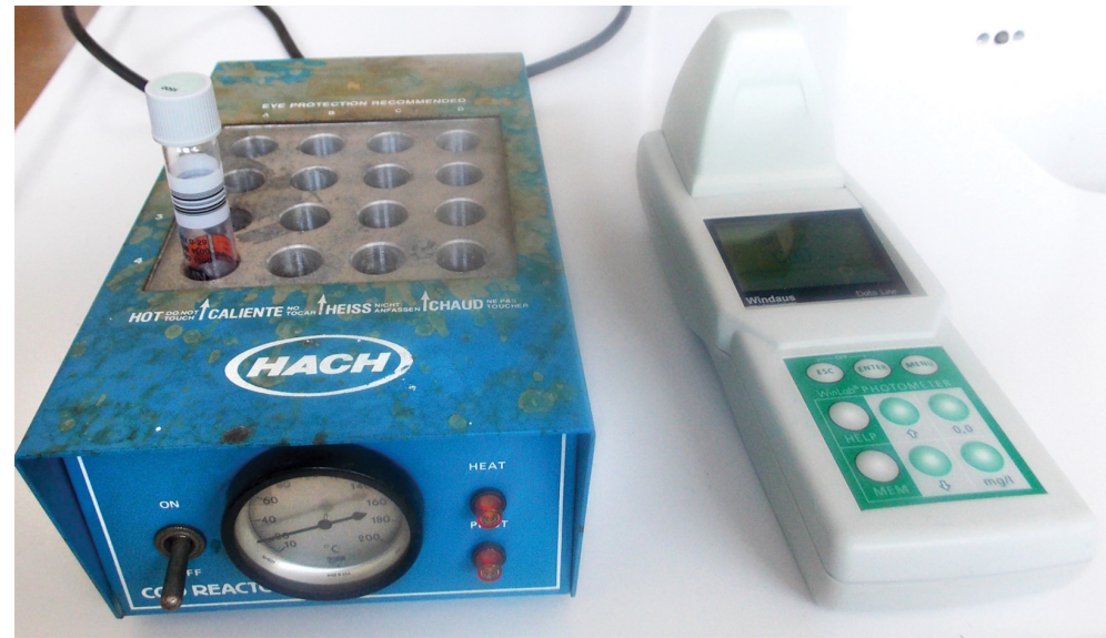
Εργαστηριακό όργανο για τη Μέτρηση COD
