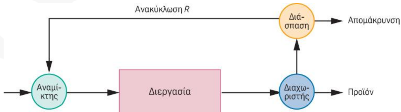
Σχήμα 12.11 Διεργασία με καθαρισμό στο ρεύμα ανακύκλωσης.
