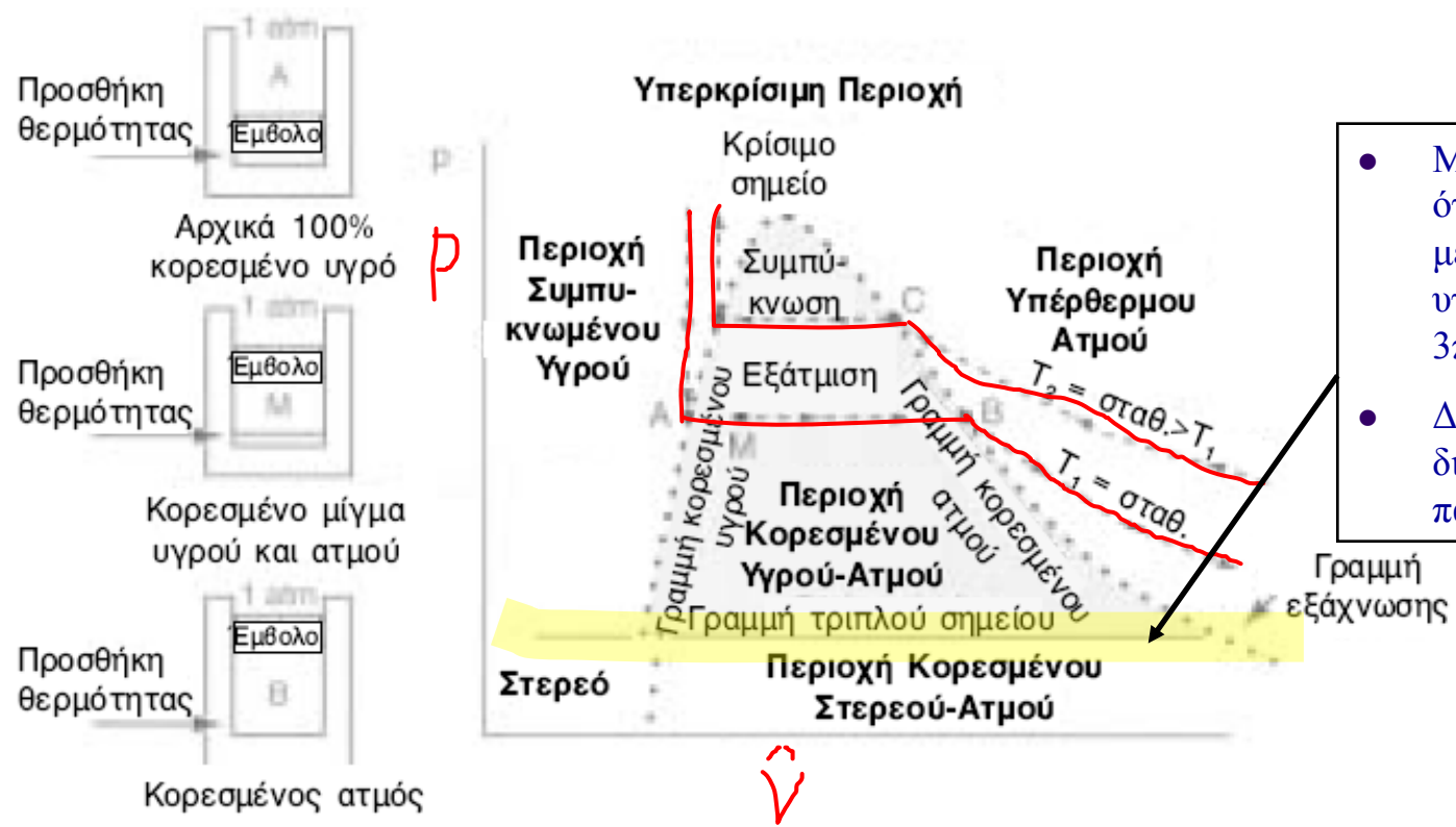
Σχήμα 16.4 Πειράματα για την δημιουργία διαγράμματος φάσεων p-\hat{V} . Οι διακεκομμένες γραμμές αντιπροσωπεύουν μετρήσεις σε σταθερές θερμοκρασίες T_1 και T_2 . Οι τελείες αντιπροσωπεύουν τα σημεία στα οποία λαμβάνει χώρα η εξάτμιση ή η συμπύκνωση, αντίστοιχα, του κορεσμένου υγρού, ή ατμού, σχηματίζοντας έναν φάκελο γύρω από την περιοχή των δύο φάσεων.
