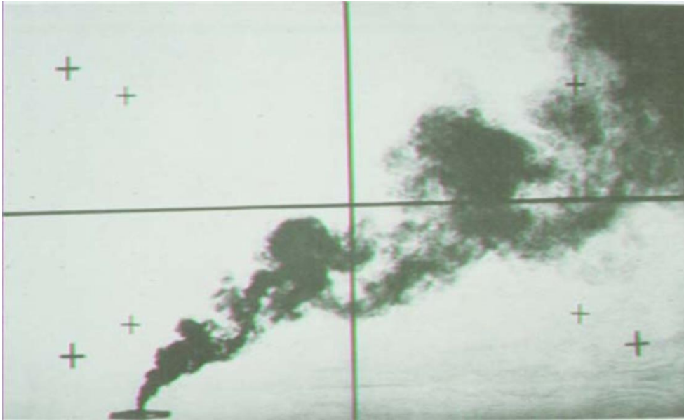
Εικόνα 11.4 Φωτογραφία εκροής από διαχυτήρα όπου διακρίνονται η σταθερή NFA και η πιο δυναμικά μεταβαλλόμενη FFA.
