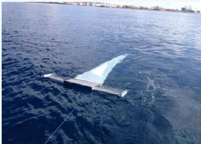
Εικόνα 4.6. Υφασμάτινα δίκτυα σε σχήμα σελάχι / χαμηλής και υψηλής ταχύτητας (Manta / hi-speed, lo-speed)
