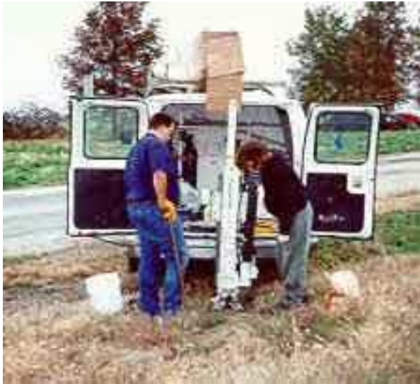
Δειγματοληψία εδάφους με Geoprobe®
