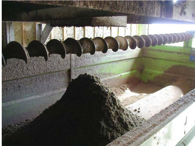
Σχήμα 6.5: Βαγόνι συλλογής των ινών, με κοχλία ως διανομέα (ANGELIDAKI, 2005)
