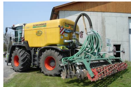
Σχήμα 6.3: Οχήματα για τη διασπορά του κομπόστ ως λίπασμα με την χρήση ευλύγιστων σωλήνων (AGRINZ GmbH)
