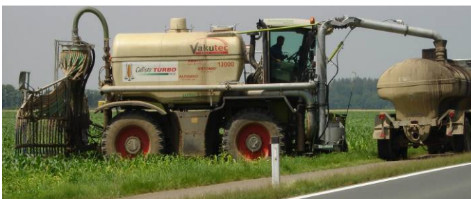
Σχήμα 6.3: Οχήματα για τη διασπορά του κομπόστ ως λίπασμα με την χρήση ευλύγιστων σωλήνων (AGRINZ GmbH)
