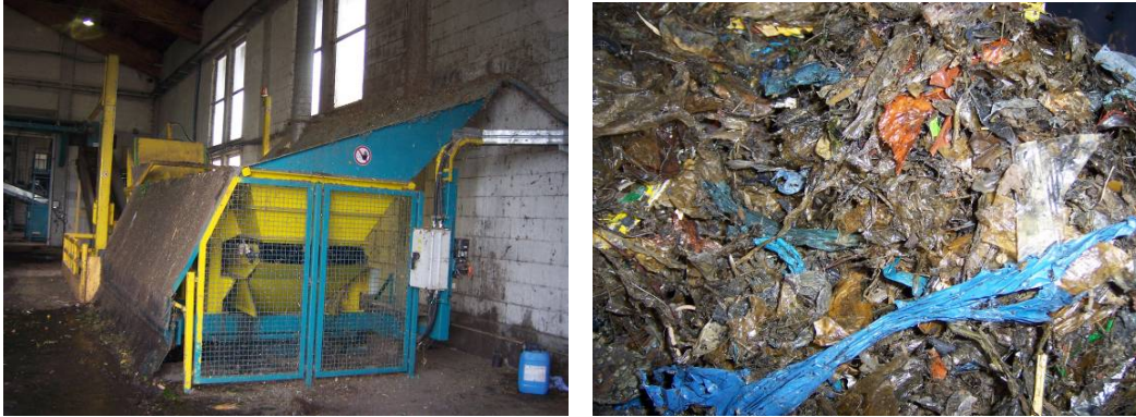
Σχήμα 7.7: Σύστημα τροφοδότησης για καθαρισμένα αστικά στερεά απόβλητα (αριστερά) και «προβληματικό υλικό» που έχει διαχωριστεί από απόβλητα σίτισης (δεξιά) (RUTZ 2007)
