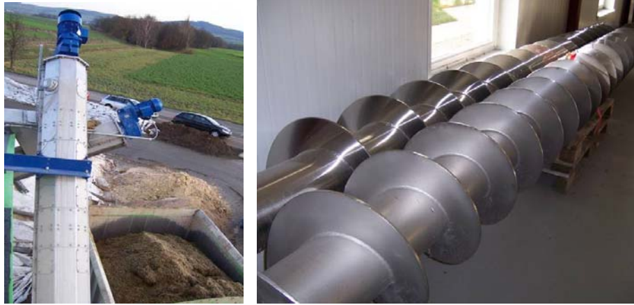
Σχήμα 7.12: Σύστημα μεταφοράς κοχλιωτής σωλήνας (αριστερά) και μεταφορικοί κοχλίες έτοιμοι για εγκατάσταση (δεξιά) (RUTZ, 2007)
