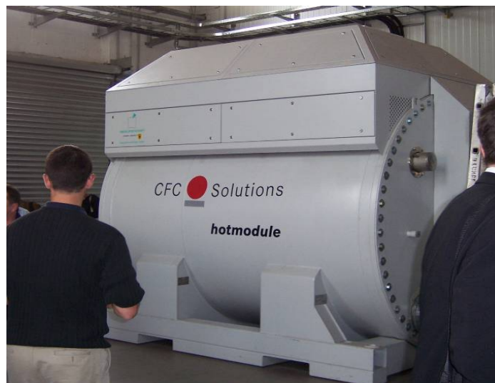
Σχήμα 5.6: Η πρώτη παγκοσμίως κυψέλη καυσίμου τύπου MCFC για βιοαέριο, που λειτουργεί στη Γερμανία (RUTZ, 2007)
