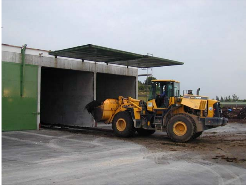
Σχήμα 7.18: Χωνευτήρας τύπου γκαράζ, τροφοδοτούμενος από φορτωτή (BEKON, 2004)
