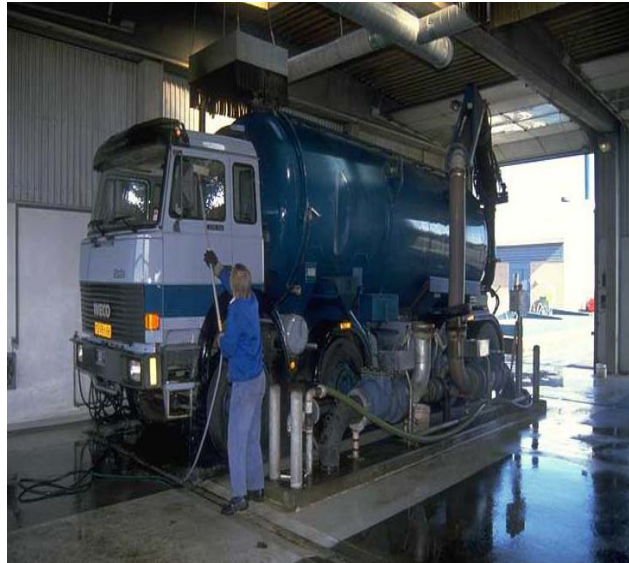
Σχήμα 9.1: Παράδειγμα μιας τυποποιημένης διαδικασίας καθαρισμού στην Μονάδα Βιοαερίου Ribe στη Δανία (AL SEADI, 2000)
