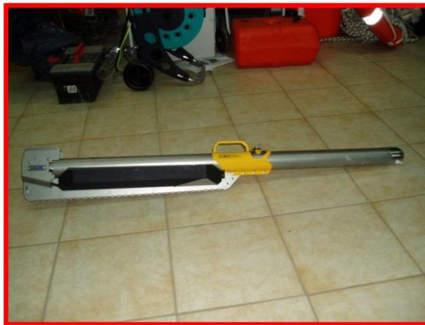
Σχήμα 5.4. Ο Ηχοβολιστής Πλευρικής Σάρωσης του Εργαστηρίου. Ο ήχος εκπέμπεται και λαμβάνεται από τα μαύρα πτερύγια στο πίσω μέρος της τορπίλης.
