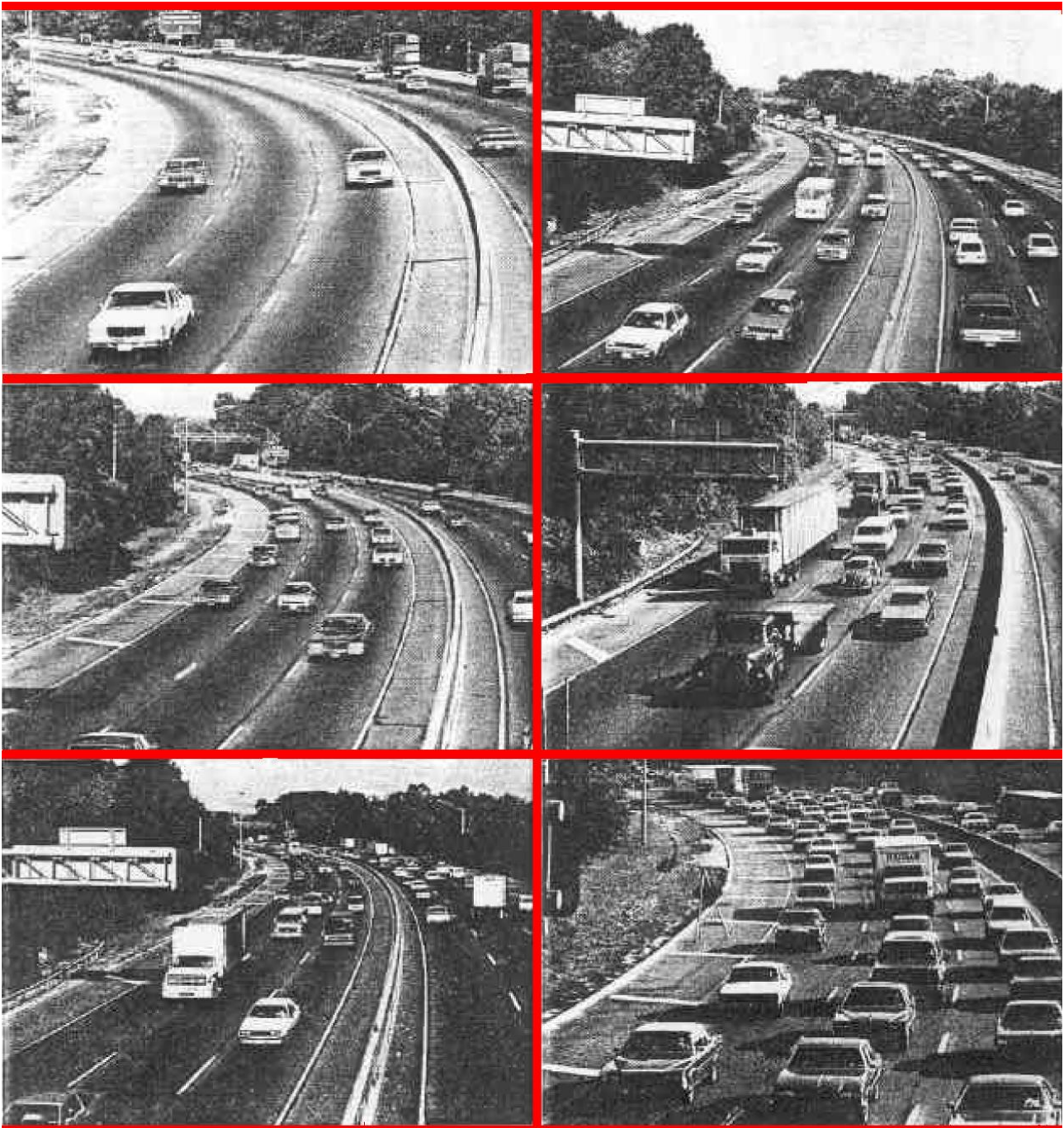
Εικόνα 5.4 Ποιότητα Κυκλοφορίας σε οδικό τμήμα σε διαφορετικές χρονικές στιγμές. Από επάνω αριστερά προς τα κάτω και δεξιά, επίπεδα εξυπηρέτησης A, B, C, D, E και F.
