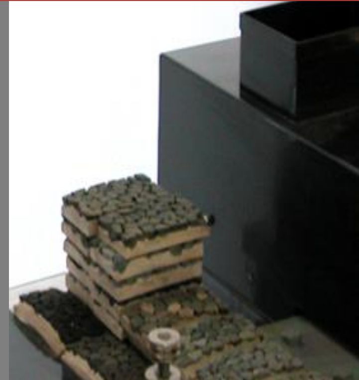
Δοκίμια αδρανών από κυρτή μεταλλική μήτρα
