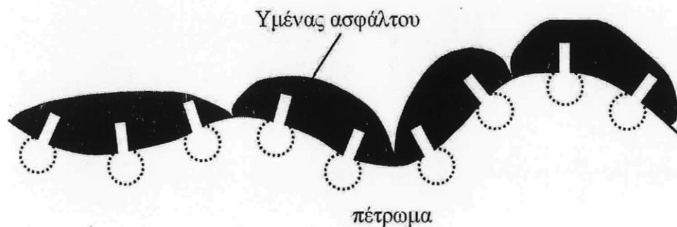
(γ) Συσσωμάτωση και εναπόθεση των σωματιδίων της ασφάλτου
