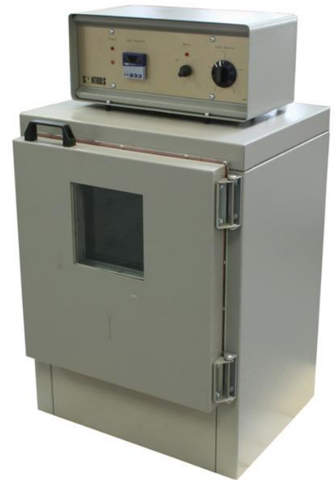
Φούρνος για τη δοκιμή απώλειας βάρους μετά από θέρμανση
