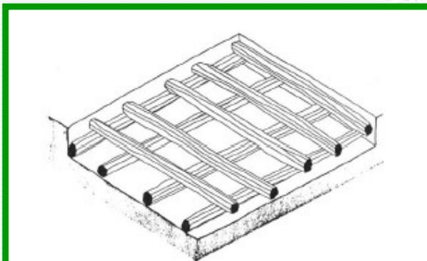
**1. Υποθεμελίωση: 3στρώτη εσχάρα ξύλινων δοκών → Διευκόλυνση εργατών κατά την δόμηση της θεμελίωσης**
