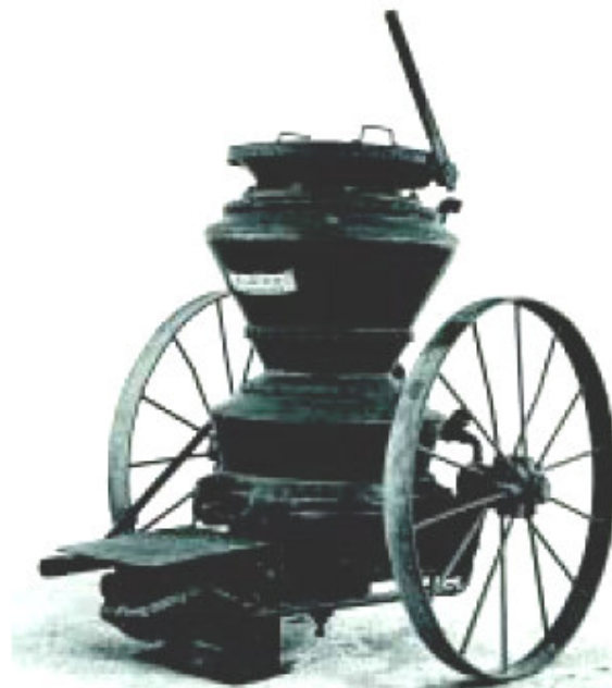
Εικόνα 1: Η πρώτη μηχανή εκτοξευόμενου Σκυροδέματος που χρησιμοποιήθηκε από τον Carl Akeley το 1907 (φώτο του J.J. Shideler, Portland Cement Association), [14]
