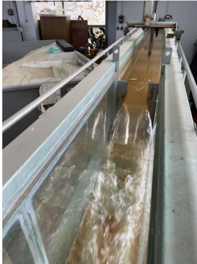
Εικόνα 2.8 Ορθογωνικός υπερχειλιστής τοποθετημένος μέσα στον ανοιχτό αγωγό
