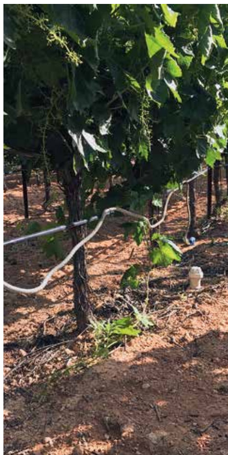
Εικόνα 1: Εγκατάσταση ηλεκτρονικών αισθητήρων για τη μέτρηση εδαφικών παραμέτρων σε αμπελώνα της περιοχής της Στιμάγκας.
