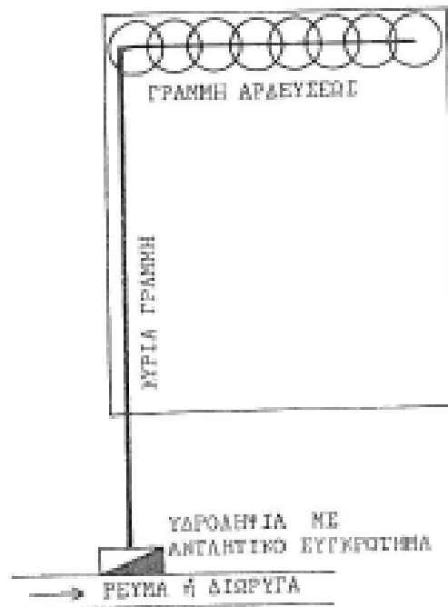
Εχ. 7.1 Τυπικό ατομικό δίκτυο αρδύσεως με καταλυισμό
