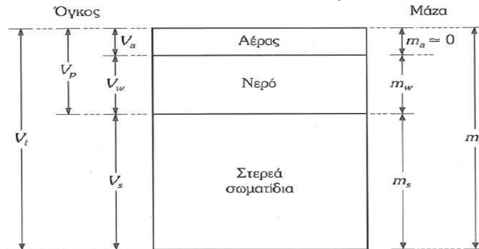
Σχ. 4.1: Διάγραμμα διαχωρισμού του συστήματος των τριών φάσεων του εδάφους.
