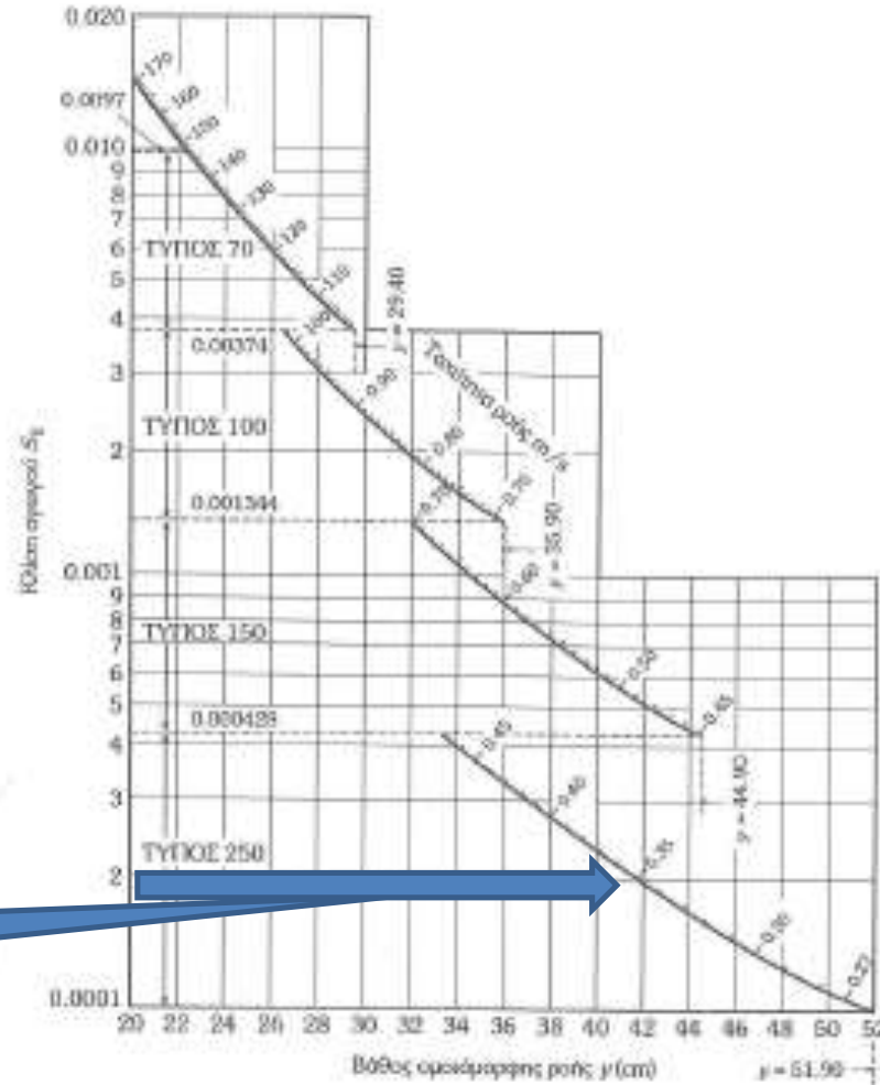
Σκ. 8.13: Νομογράφημα υπολογισμού του βάθους ομοιόμορφης ροής σε ληκωτισκευασμένους αγωγούς ελλειψοειδούς διατομής (καναλιέτα) για παροχή 60 L/s.
