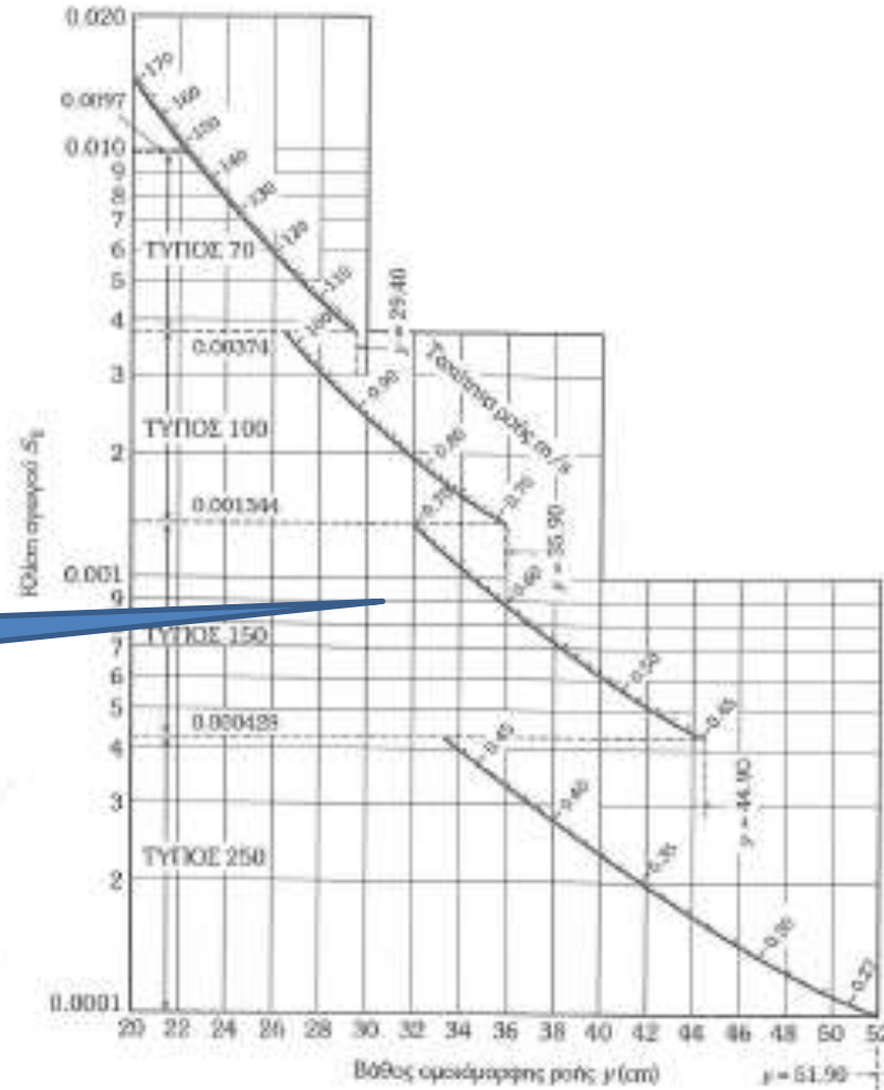
Σκ. 8.13: Νομογράφημα υπολογισμού του βάθους ομοιόμορφης ροής σε λισσοειδή διατομή (καναλιέτα) για παροχή 60 L/s.
