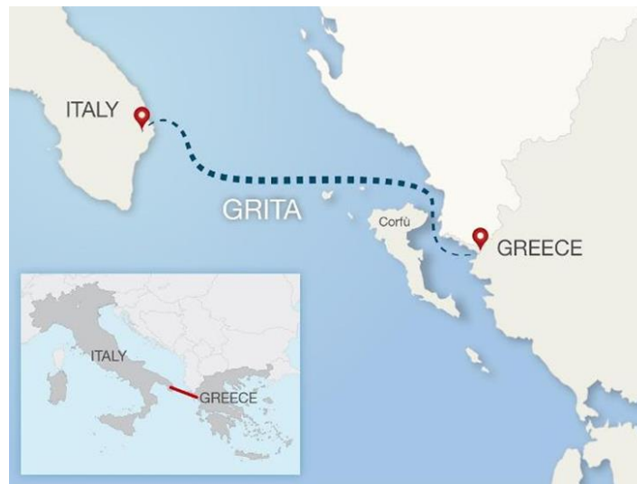
Σχήμα 7.5: Ηλεκτρική HVDC διασύνδεση Ελλάδας-Ιταλίας [10].
