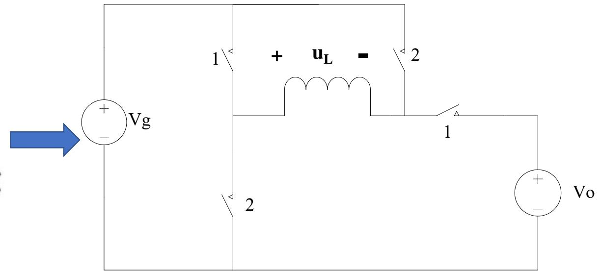
$$(V_g - V_o)D - V_g(1-D) = 0 \Rightarrow V_g(D-1+D) + V_o(-D) = 0 \Rightarrow$$
