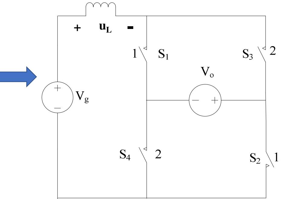
$$(V_g + V_o)D + (V_g - V_o)(1 - D) \Rightarrow V_g(D + 1 - D) + V_o(D - 1 + D) = 0 \Rightarrow$$
