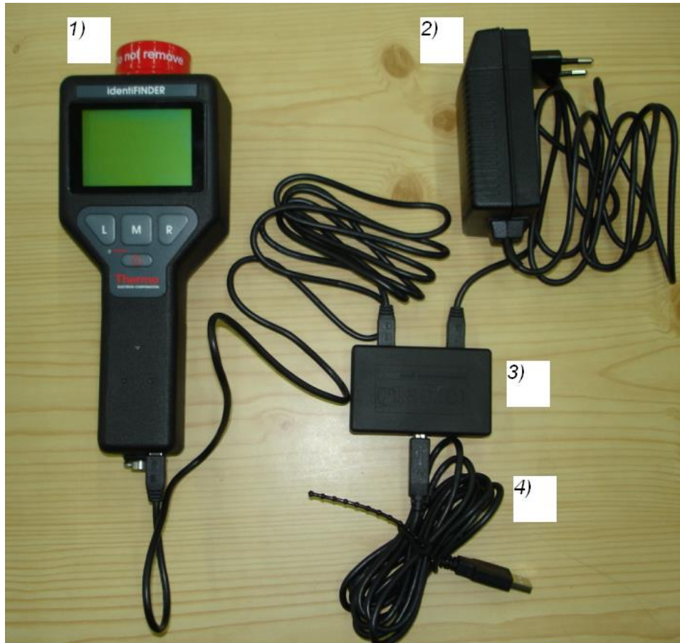
Σχήμα 5.10 1) Ανιχνευτής (συσκευή), 2) Φορτιστής, 3) HUB (συσκευή για διακλάδωση των καλωδίων της συσκευής), 4) Καλώδιο USB για σύνδεση της συσκευής με τον υπολογιστή
