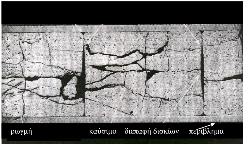
Σχήμα 6.6 Ρωγμές σε δισκία καυσίμου μέσα στη ράβδο του εξαντλημένου καυσίμου (clad-περίβλημα, fuel-καύσιμο)
