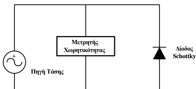
Σχήμα 1: Κύκλωμα μέτρησης χωρητικότητας-τάσης
