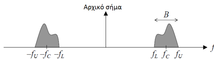
Σχήμα 4.5 Φάσμα αρχικού πραγματικού σήματος. Παρατηρούμε τις θετικές και τις αρνητικές φασματικές συνιστώσες του σήματος, [50, σελ. 20].
