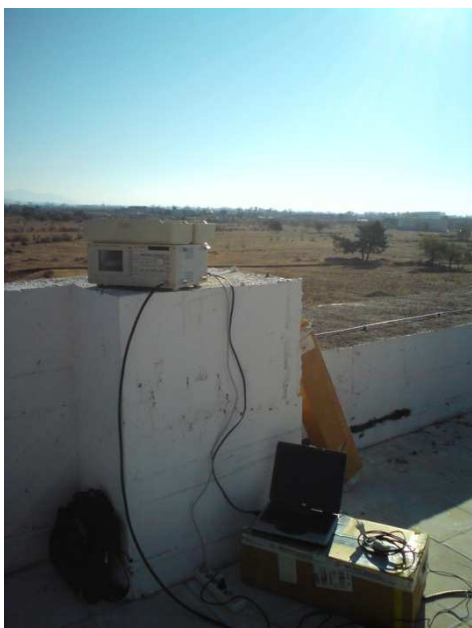
Εικόνα 5.1 Σύνδεση αναλυτή φάσματος ADVANTEST R3131 με laptop
