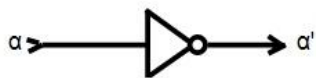
Πίνακας 4.1 Ο πίνακας αληθείας της πύλης NOT και η γραφική της παράσταση
