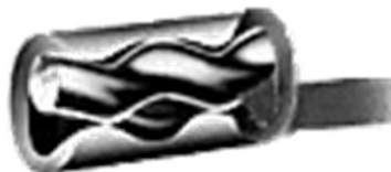
Σχ. 3.21. Αρχή λειτουργίας αντλίας αεζυό κοχλίου (Μογίνο)
