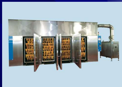
Σχ. 7.24. Σχηματική παράσταση "φούρνου" ξήρανσης (Kiln drier)
