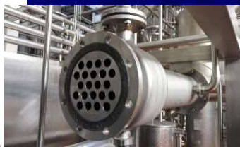
Σχ. 5.6. Εναλλάκτης σωλήνων-κελύφους είσοδο 1-1 με βασικό διατομή (1)
