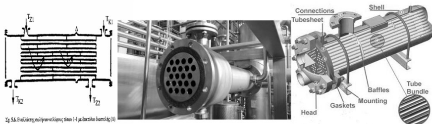
Σχ. 5.6. Εναλλάκτης σωλήνων-κέλυφος τύπου 1-1 με διατετακτο διατετακτός (1)
