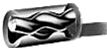
Σχ. 3.21. Αρχή λειτουργίας αντλίας αεζιό κοχλίου (Μογνο)
