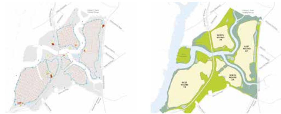
ΕΙΚΟΝΑ 36: ΥΦΙΣΤΑΜΕΝΟ ΔΙΚΤΥΟ ΥΠΟΔΟΜΩΝ ΣΤΟ FRESH KILLS ΜΕ ΔΕΞΑΜΕΝΕΣ ΟΜΒΡΙΩΝ ΥΔΑΤΩΝ, ΣΥΣΤΗΜΑ ΣΥΛΛΟΓΗΣ ΔΙΗΘΗΜΑΤΩΝ, ΓΕΩΤΡΗΣΕΙΣ ΠΑΡΑΚΟΛΟΥΘΗΣΗΣ ΚΑΙ ΔΙΚΤΥΟ ΣΥΛΛΟΓΗΣ ΒΙΟΑΕΡΙΟΥ. ΠΗΓΗ: (FIELD OPERATIONS, 2006) ΕΙΚΟΝΑ 37: ΑΠΟΤΥΠΩΣΗ ΤΩΝ ΤΕΣΣΑΡΩΝ ΚΥΡΙΩΝ ΑΝΑΧΩΜΑΤΩΝ ΑΠΟΡΡΙΜΜΑΤΩΝ ΠΗΓΗ: (FIELD OPERATIONS, 2006)
