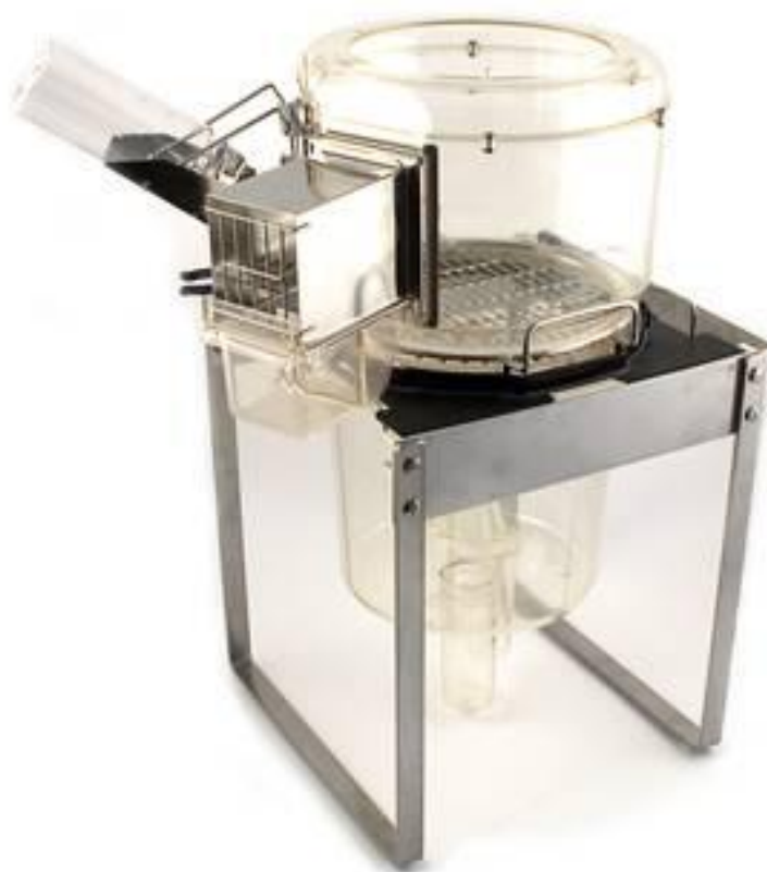
Εικόνα 7.5 Μεταβολικό κλουβί τρωκτικών.
