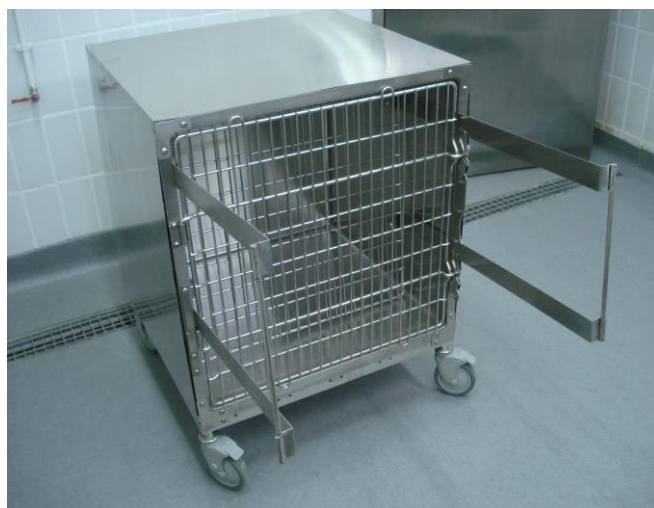
Εικόνα 5.7 Κλουβί περιορισμού με κινούμενη κάθετη επιφάνεια.
