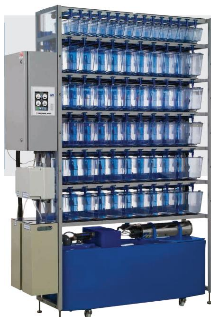
Εικόνα 24.4 Συστοιχία δεξαμενών διατήρησης ζεβρόψαρων.
