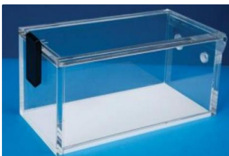
Εικόνα 8.2 Αεροστεγής κλωβός εγκατάστασης αναισθησίας τρωκτικών.
