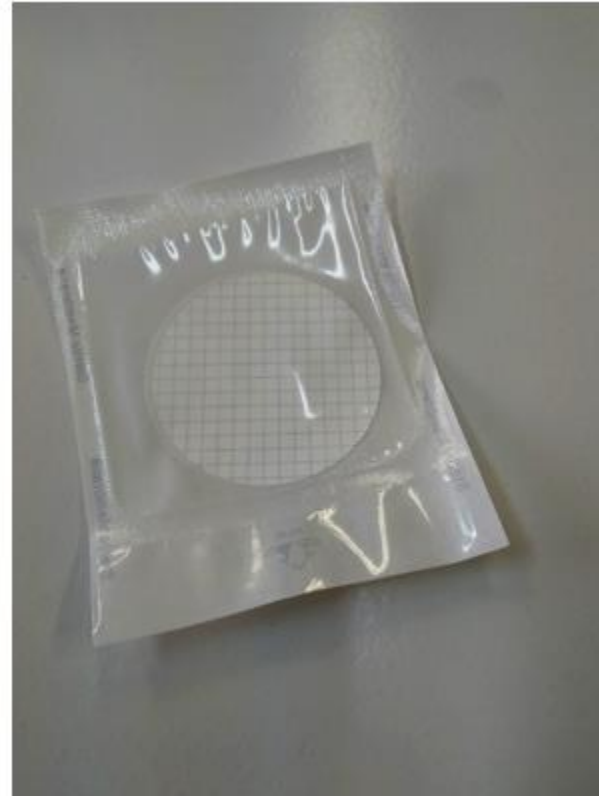
Φίλτρο μικροδιήθησης (0.45 \mu\text{m} )
