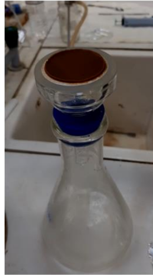
Στρώμα επικαθήσεων (στερεά) μετά την ολοκλήρωση της διήθησης
