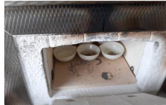
Αποτέφρωση δείγματος στους 550 °C
