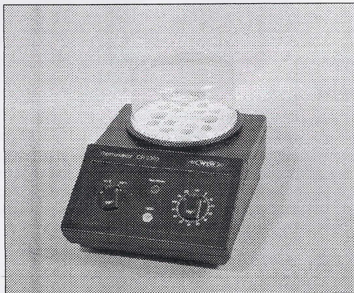
Εικόνα 1. Συσκευή επώασης για τον προσδιορισμό του COD
