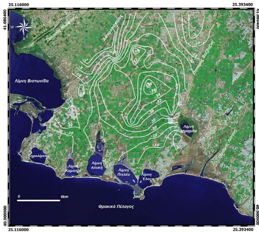
Σχήμα 4.20. Πιεζομετρικοί χάρτες περιοχής έρευνας (επάνω: Απρίλιος 2005, κάτω: Οκτώβριος 2005) (Kalloras et al., 2006, Καλλιώρας, 2008).
