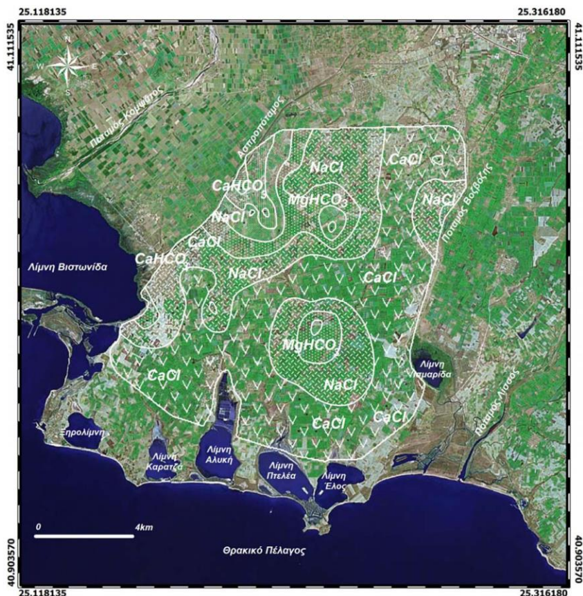
Σχήμα 4.25. Χωρική κατανομή χρωματογραφικών υδροχημικών τύπων των υπόγειων νερών της περιοχής έρευνας κατά τη διάρκεια της δειγματοληψίας του έτους 2005 (υπόβαθρο Google Earth) (Kalloras et al., 2006, Καλλιώρας, 2008).
