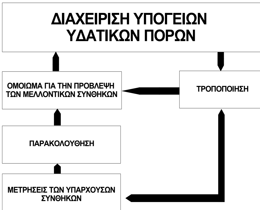
Σχήμα 5.1. Σχηματική απόδοση διαχειριστικού πλαισίου για το φαινόμενο της θαλάσσιας διείσδυσης.
