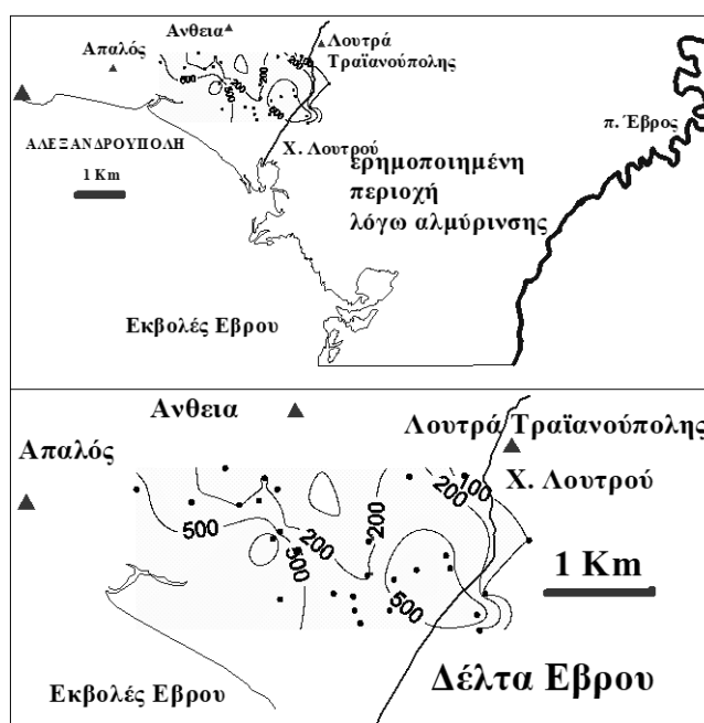
Σχήμα 4.29. Κατανομή του Cl - (mg/L) στα υπόγεια νερά του Δέλτα του Π. Έβρου (Πεταλάς κ.ά., 2002a).
