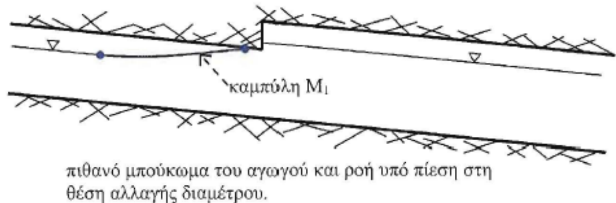
(β) Αλλαγή διαμέτρου αγωγού με ταύτιση πυθμένα
