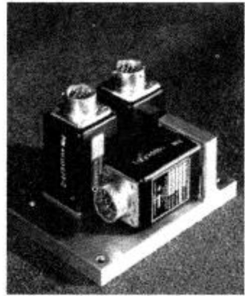
**Σχήμα.** Λειτουργία επιταχυνσιομέτρου και επιταχυνσιόμετρο τριών αξόνων αποτελούμενα από τρία ξεχωριστά επιταχυνσιόμετρα, αναρτημένα έτσι ώστε να σχηματίζουν ορθές γωνίες μεταξύ τους.
