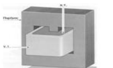
Μετασχηματιστής τύπου Μανδύα
