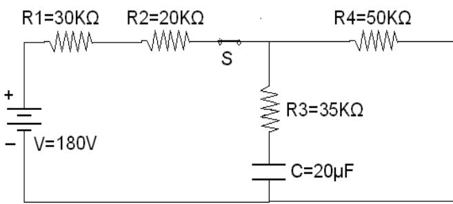
η πηγή ρεύματος μετατρέπεται σε πηγή τάσης  $V = I \times R = 6 \text{ mA} \times 30 \text{ k}\Omega = 180 \text{ V}$  και προκύπτει το διπλανό κύκλωμα.
