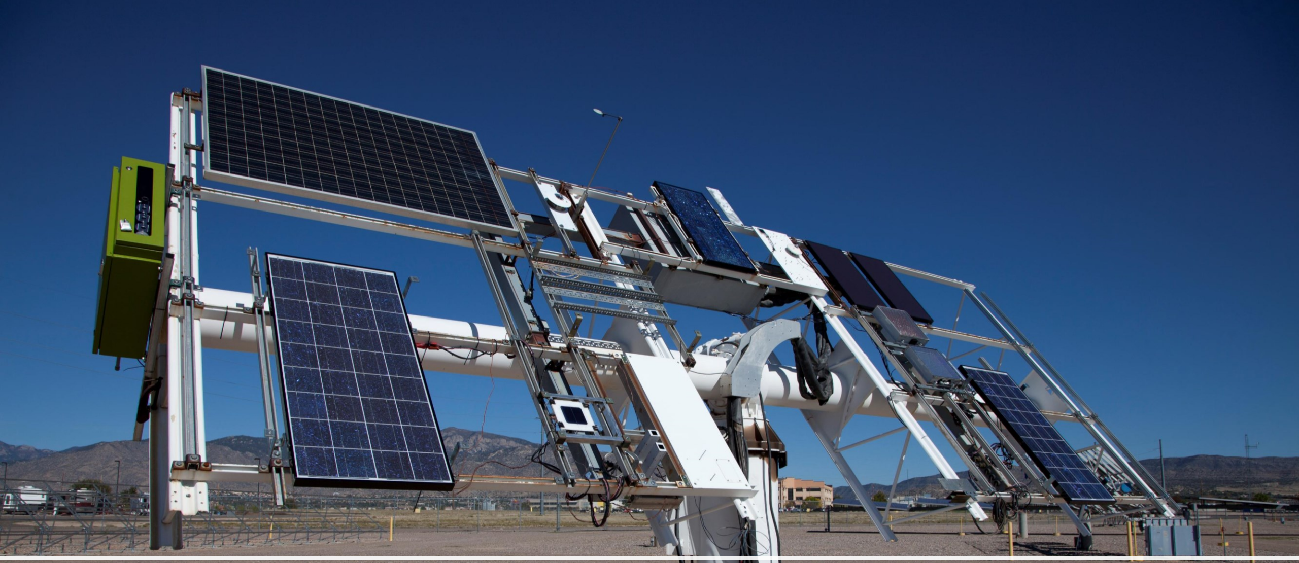
Προσανατολισμός ΦΒ Συστοιχίας Two-axis tracking
