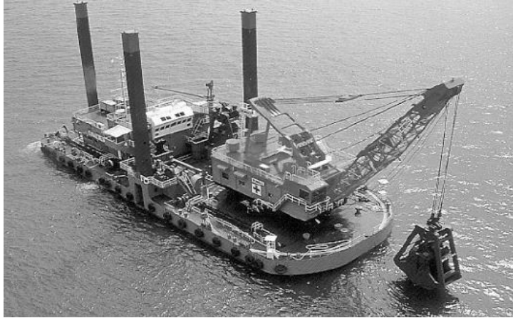
Άποψη πραγματικής βυθοκόρου με αρπαγή (Πηγή: Vlasblom, 2003)
