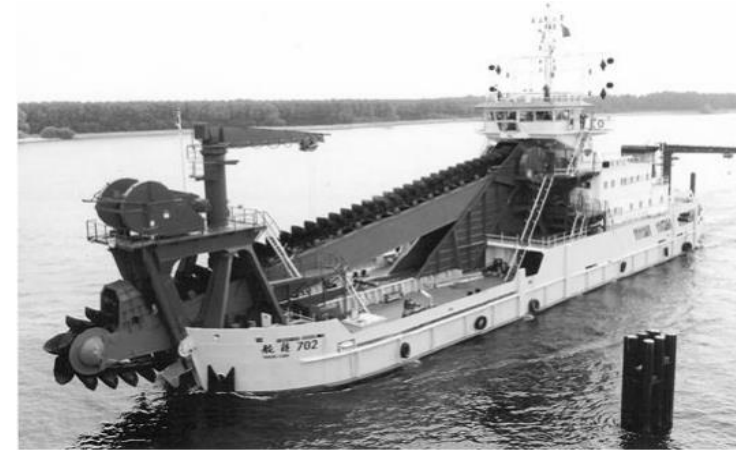
Άποψη πραγματικής βυθοκόρου με αλυσίδα των κάδων (Πηγή: Vlasblom, 2003)
