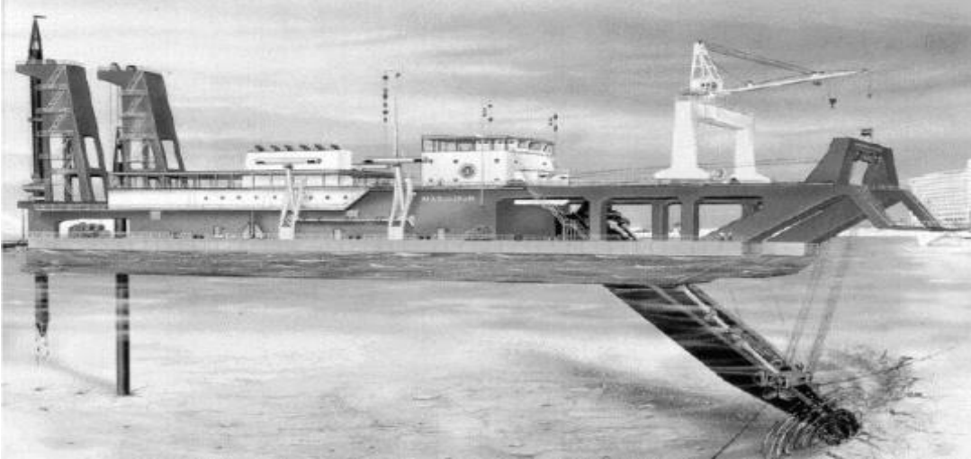
Άποψη βυθοκόρου με κεφαλή κοπής. (Πηγή: Vlasblom 2003)
