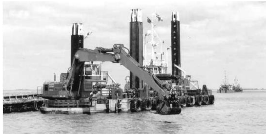
Άποψη πραγματικής βυθοκόρου με υδραυλικό βραχίονα (Πηγή: Vlasblom 2003)
