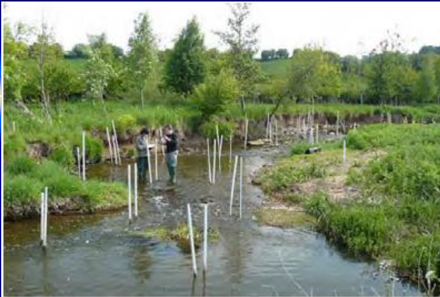
Σχήμα 8.1 Δίκτυο μίνι πιεζομέτρων (σωλήνες PVC) εγκατεστημένα για παρακολούθηση VHGs (Vertical Hydraulic Gradient) και διαρροές στο ποτάμι (photo: Daniel Käser).
