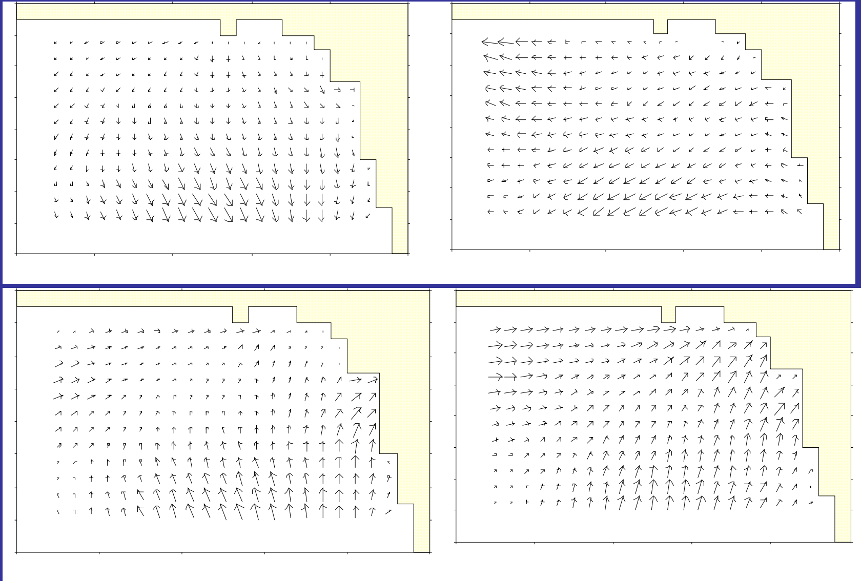
Σχήμα 2. Προσομοίωση ολοκληρωμένης κατά το βάθος παλιρροιακής ροής στο Κόλπο Αλεξανδρούπολης για παλιρροιακό κύμα εύρους 20 cm (χρόνος προσομοίωσης : ε) 60 ώρες, στ) 63 ώρες).
