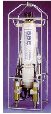
Σχήμα 2.1. Το όργανο CTD της εταιρείας Seabird (δεξιά) και μία ροζέτα από δειγματοληπτικές φυάλες με CTD στο κέντρο της (αριστερά).
