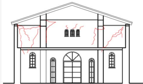
(α) Δυτική Όψη, διάταξη ρηγματώσεων σε εκτός επιπέδου κάμψη εσωτερικά
