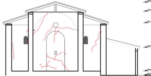
(β) Ανατολική Όψη, διάταξη ρηγματώσεων σε εκτός επιπέδου κάμψη, εξωτερικά
