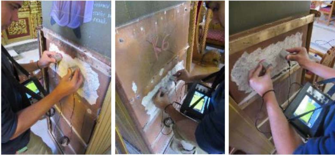
Εικόνα 13: Φωτογραφική τεκμηρίωση μετρήσεων με υπερήχους στα υποστυλώματα των τοξοστοιχιών.
