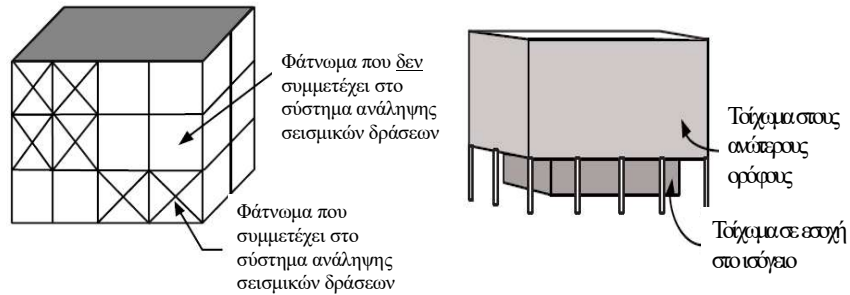
Σχ. Σ5.1 Παραδείγματα μή-κανονικότητας καθύψος: Διακοπή φορέα καθύψος (αριστερά), εκτός επιπέδου εσοχή (δεξιά)
