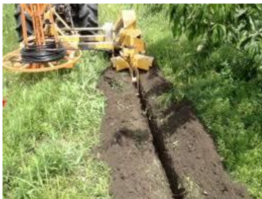
Εικόνα 1-21 – σκαπτικός δίσκος για υπόγεια άρδευση
