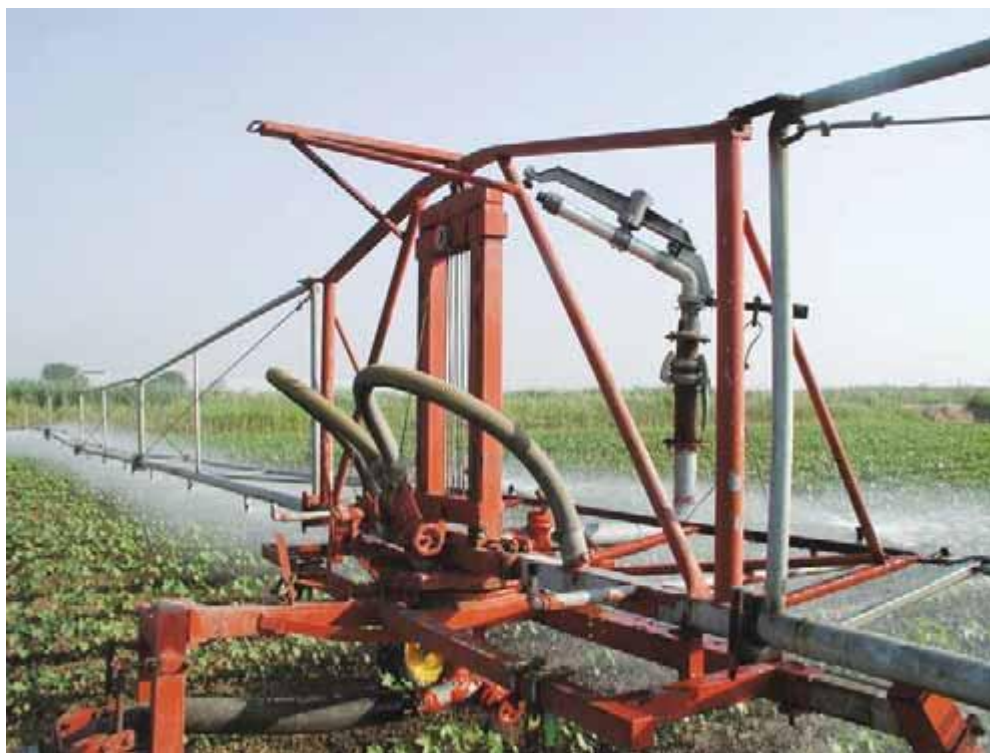
Εικόνα 1-15 Σύστημα καρουλιού με αυτοπροωθούμενο μεγάλο εκτοξευτήρα και αυτοπροωθούμενη ράμπα (Παπαμιχαήλ, Μπαμπατζιμόπουλος 2014)
