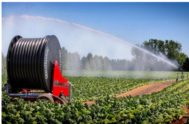
Εικόνα 1-11: άρδευση με αυτοπροωθούμενο σύστημα καταιονισμού με τον εκτοξευτήρα στο βάθος
