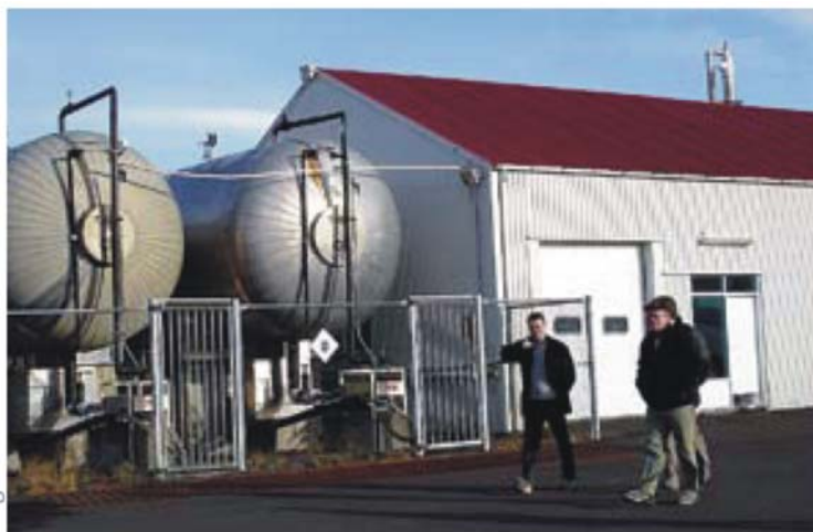
Μονάδα ανάκτησης CO 2 από γεωθερμικά ρευστά στο Haedarendi της Ισλανδίας [Πηγή: “Geothermal Development and Research in Iceland”, National Energy Authority and Ministries of Industry and Commerce, 2006]
