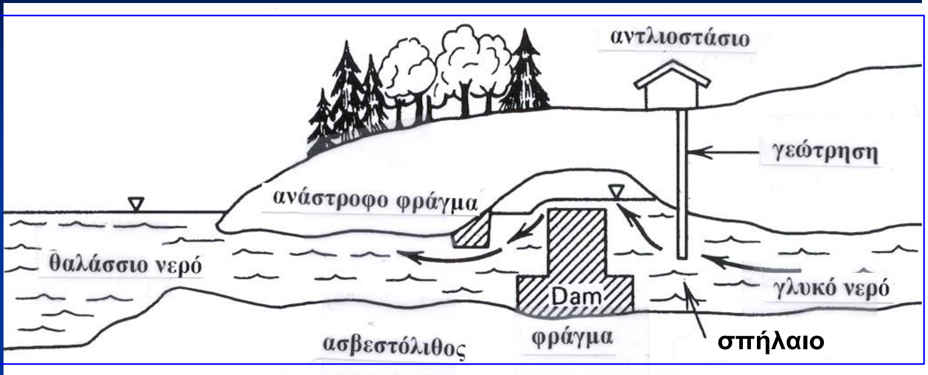
Σχήμα 9. Σχηματικό διάγραμμα ενός υπόγειου φράγματος σε ένα παράκτιο ασβεστόλιθιο σπήλαιο για την παρεμπόδιση της ανάμιξης γλυκού και αλμυρού νερού
