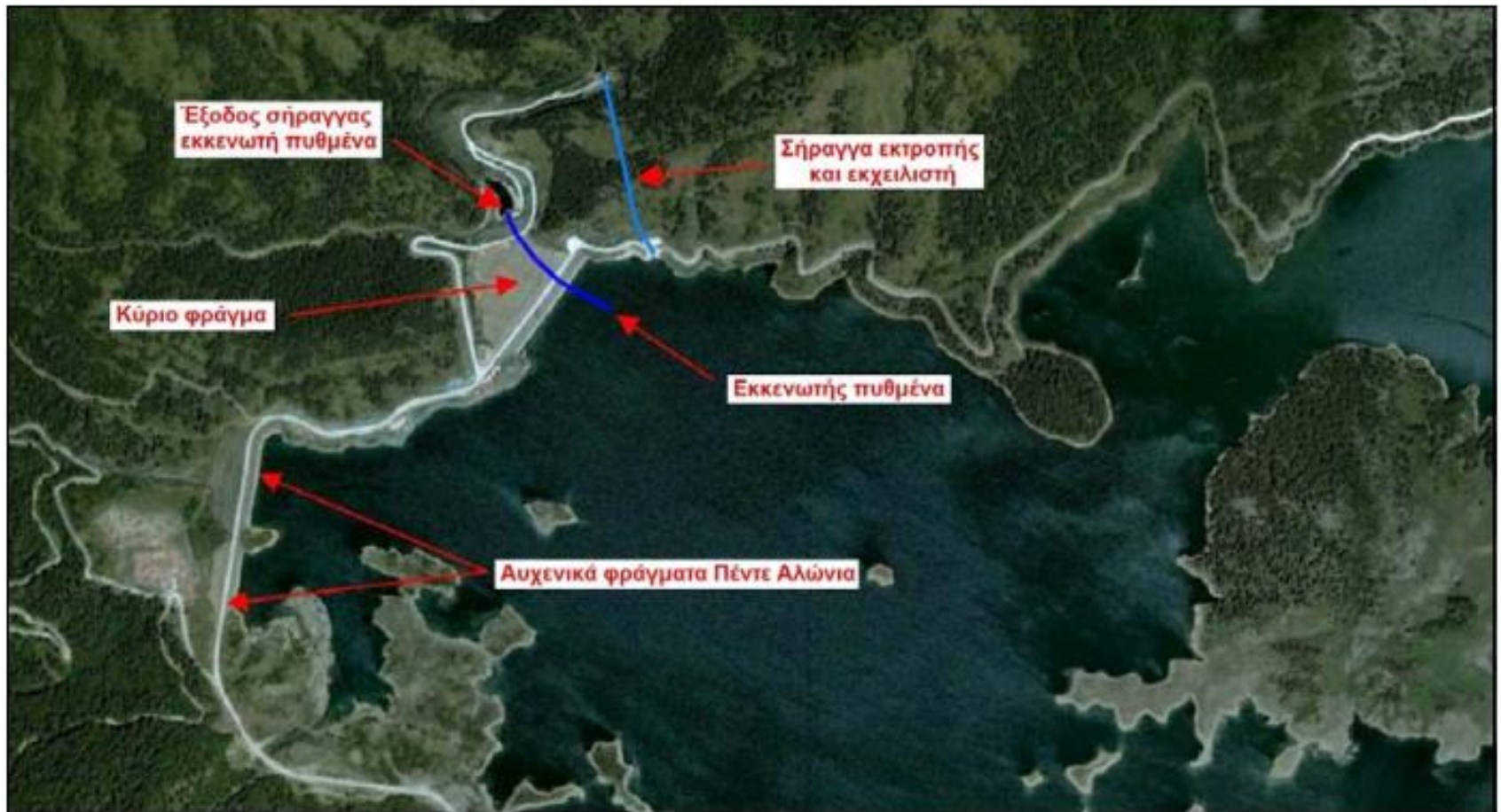
Εικόνα 5: Η περιοχή εγκαταστάσεων 2 με το κύριο φράγμα και τις σήραγγές του και τα φράγματα "Πέντε Αλώνια"
