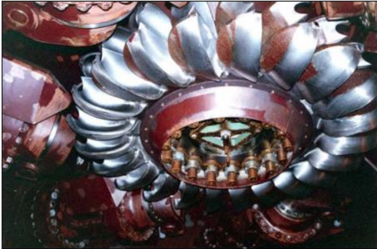
Εικόνα 14: Στροφείο στροβίλου τύπου PELTON (Πηγή: Δ/νση ΥΗΣ Πηγών Αώου)
